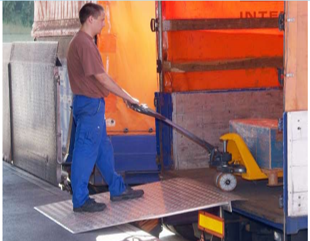
Surface de roulement en tôle damier, antidérapante.
