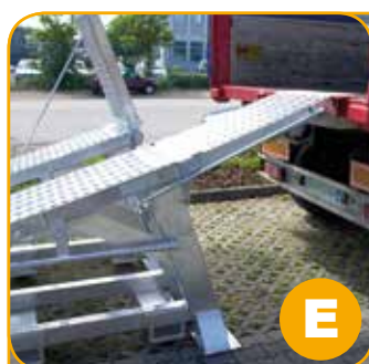
Rampe de chargement mobile, articulée et compensée.
